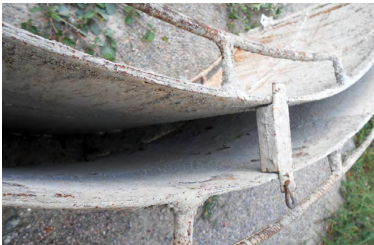
Figura 33. Vista lateral com detalhe do “separador” das formas para manter a largura de 6 cm.
