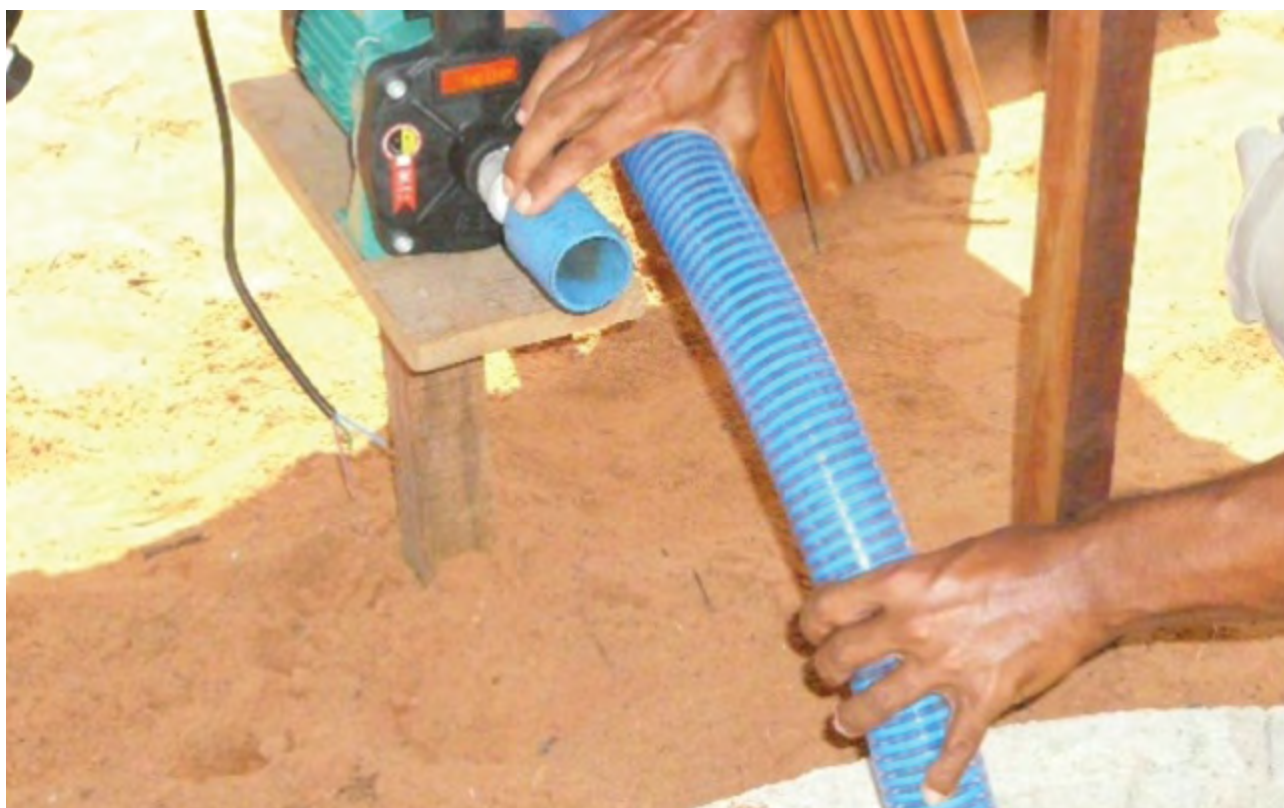
37 – Mangote de 50 mm de diâmetro.
