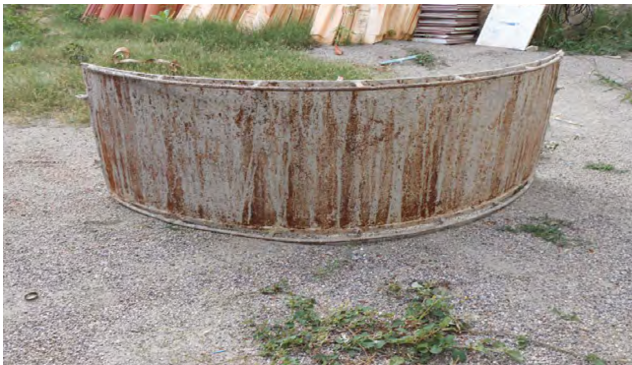
Figura 29. Peça curva externa da forma (1,75 m).
