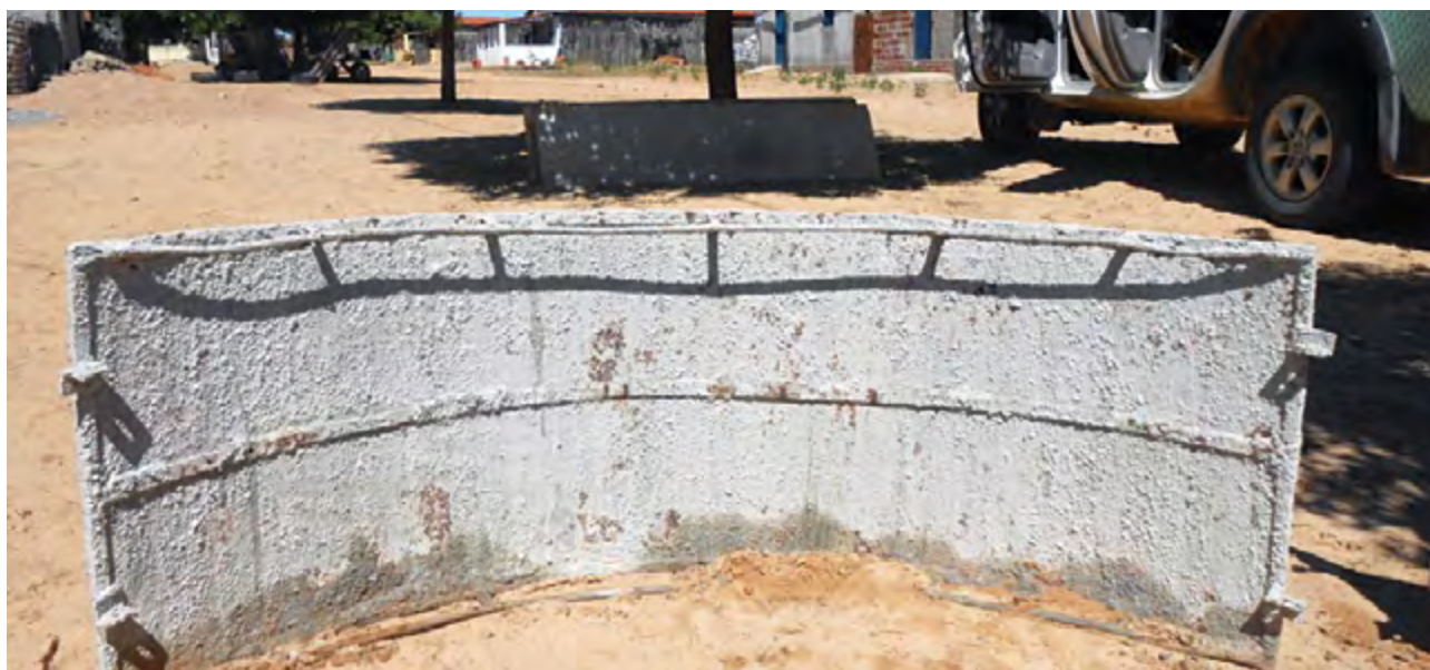
Figura 23b. Peça curva interna da forma (1,55 m). Detalhes dos “encaixes” para colocar os “pinos de amarração” entre peças.
