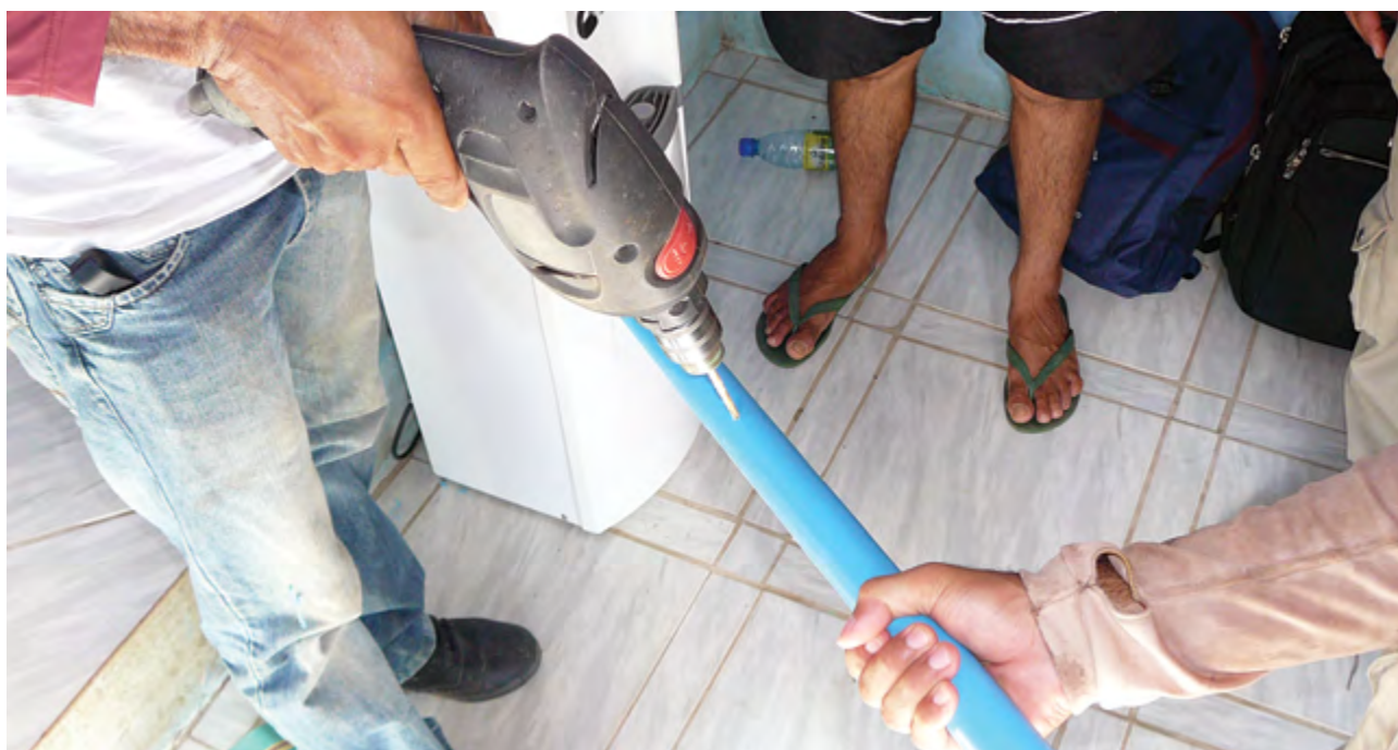
15 – Perfurando os tubos de PVC de DN 32 utilizados para a confecção do “chuveiro”. Usar uma broca de 3/16” e 5 cm de espaçamento entre os furos.
